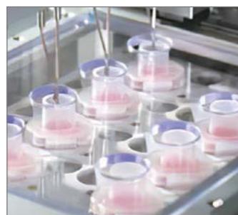
Нанесение материала на стекло и промывка
